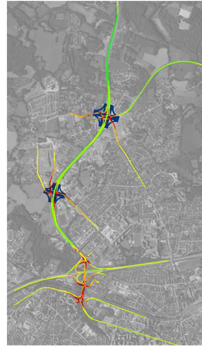
Figure 42 : Vitesses de circulation en 2027 à l'heure de pointe du soir
