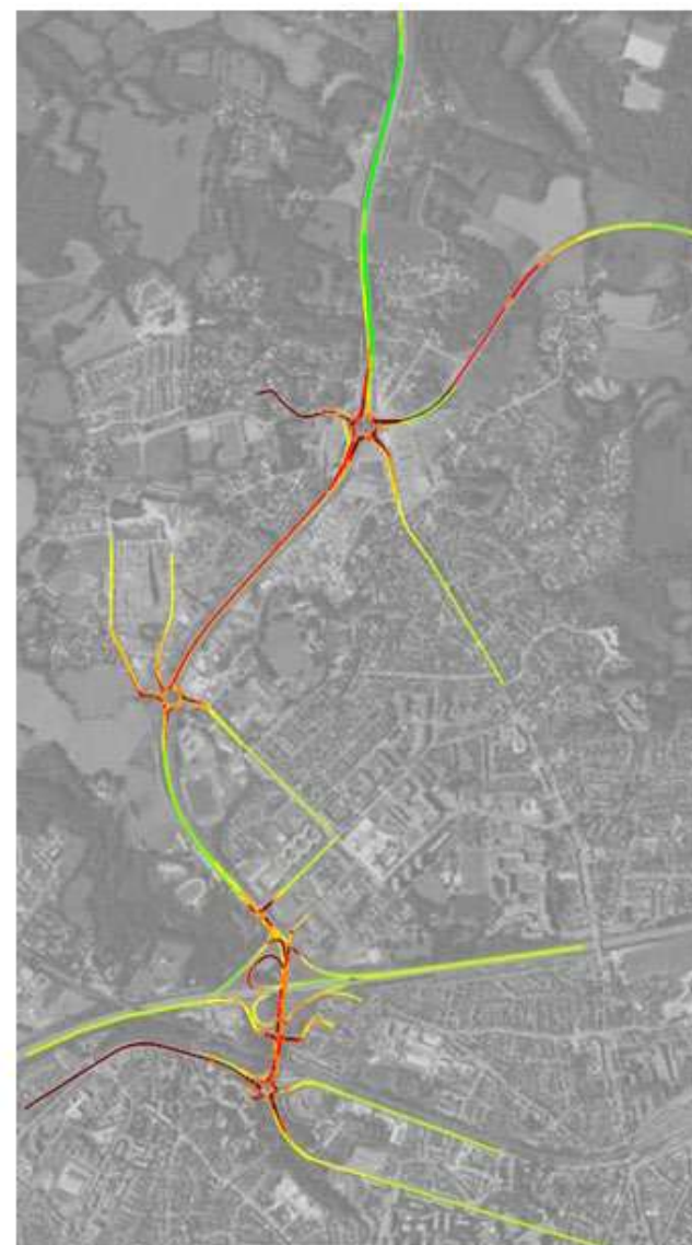
Figure 44 : Vitesses de circulation en 2047 à l'heure de pointe du soir
