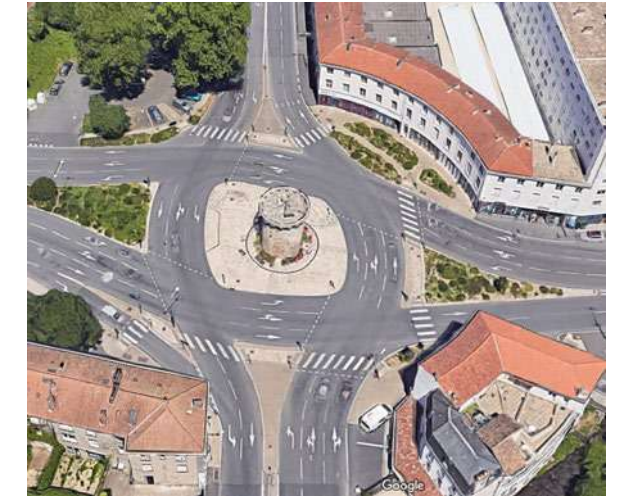
Figure 29 : Place à feux autour de la tour du Cordier à Poitiers (Google maps)
