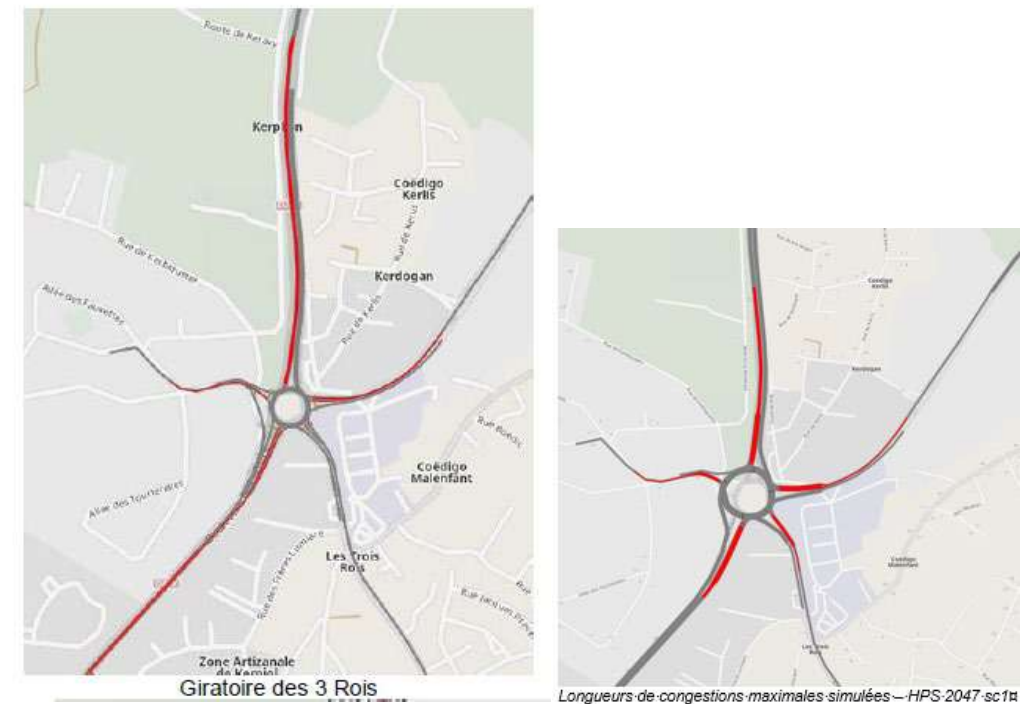
Figure 33 : Longueurs de congestion maximales en situation actuelle et avec le scénario A en 2027 à l'HPS
