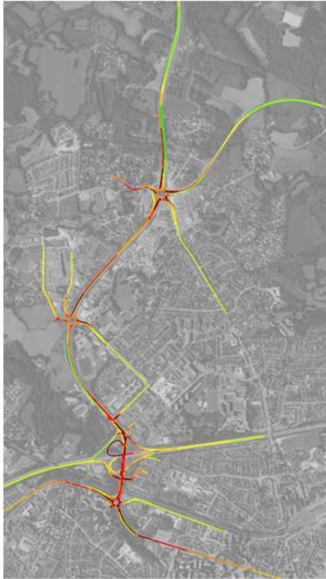
Figure 41 : Vitesses de circulation en 2027 à l'heure de pointe du matin
