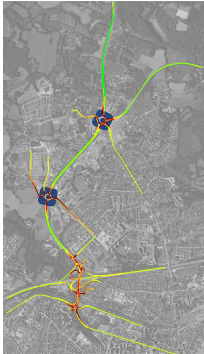
Figure 45 : Vitesses de circulation en 2047 à l'heure de pointe du matin
