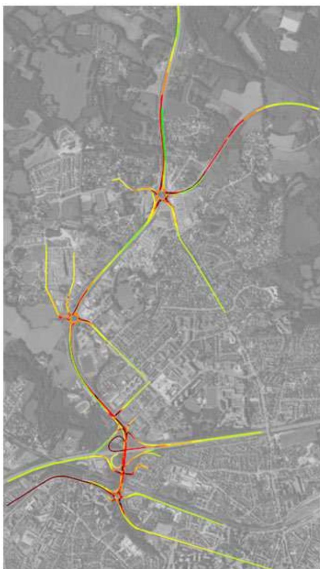
Figure 43 : Vitesses de circulation en 2047 à l'heure de pointe du matin
