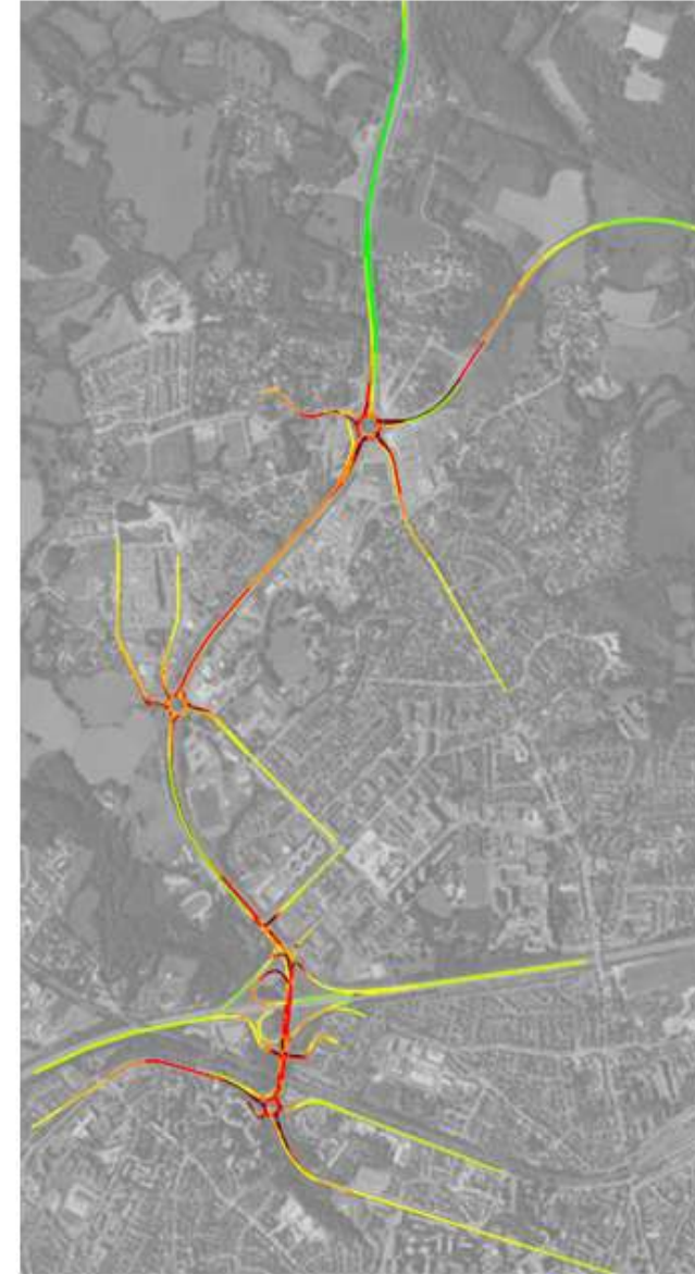
Figure 42 : Vitesses de circulation en 2027 à l'heure de pointe du soir
